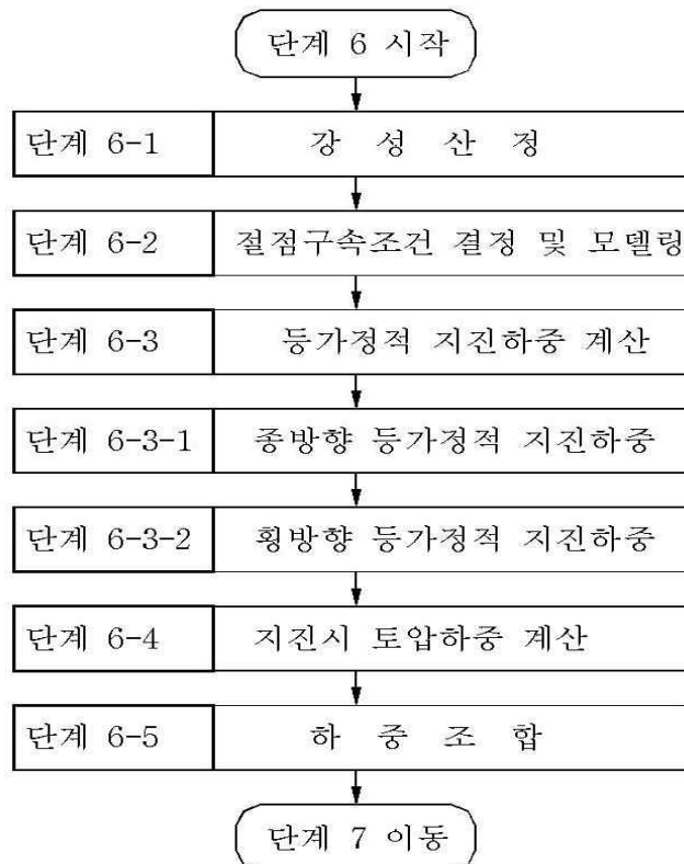
그림 24. (지진시) 구조계 모델링 및 지진하중 산정
