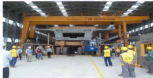
⑥ PC Box Girder 운반차량(Carrier)에 적재
