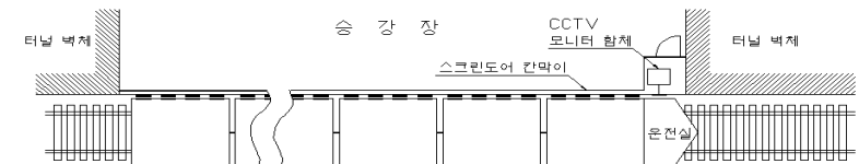
그림.1 광역철도 승강장 영상감시(CCTV) 설치 구성도
