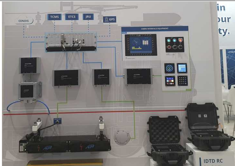
< Locomotive에 장착되는 ATP(PZB) 시스템 구성도 >
