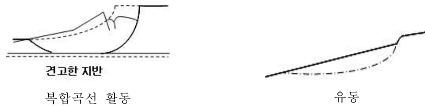
그림 3. 땅깁기 토사 비탈면의 붕괴형태[전성기, 1998]
