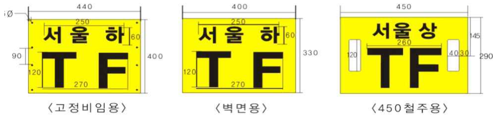
그림 7. 인출철구 급전선(AF), 전차선용급전선(TF) 표지 개념도
