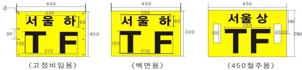
그림 6. 인출철구 급전선(AF), 전차선용급전선(TF) 표지 개념도
