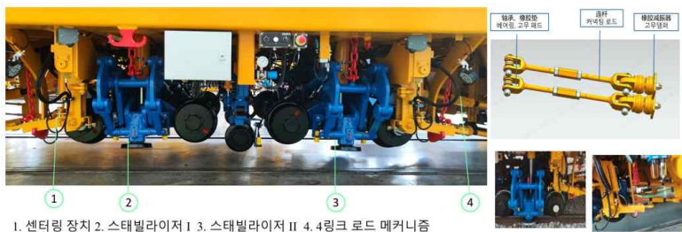
안정화장치 구조 및 유지보수
