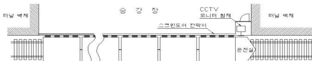
그림.1 광역철도 승강장 영상감시(CCTV) 설치 구성도
