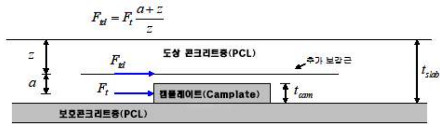
그림 19. 캠플레이트(Camplate) 위치에서의 전단보강 설계
