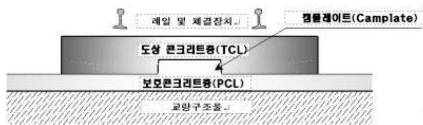
그림 17. 현장타설방식 콘크리트케도 교량부 구성요소
