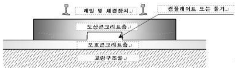
그림 17. 현장타설방식 콘크리트케도 교량부 구성요소
