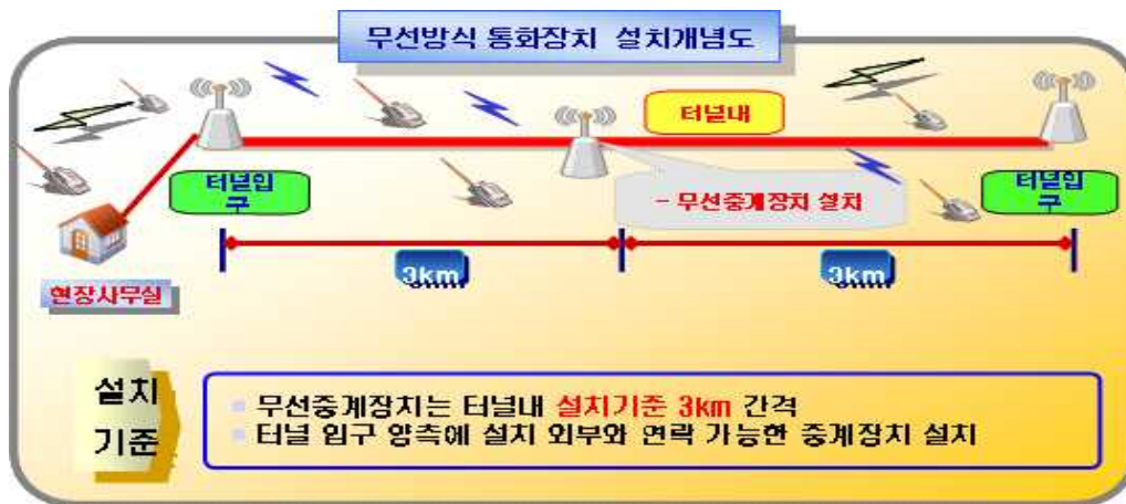
[그림3-2] 무선방식 통화장치 설치 개념도
