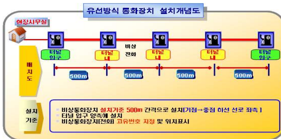
[그림3-1] 유선방식 통화장치 설치 개념도
