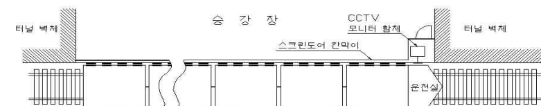
그림.1 광역철도 승강장 영상감시(CCTV) 설치 구성도
