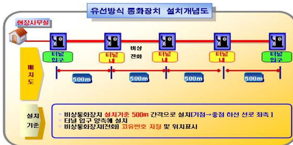
[그림3-1] 유선방식 통화장치 설치 개념도
