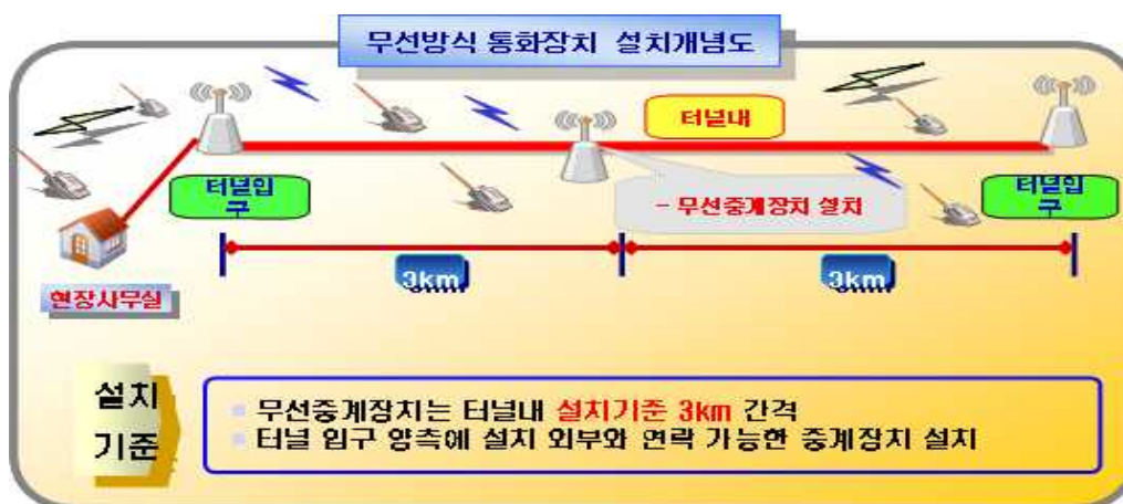
[그림3-2] 무선방식 통화장치 설치 개념도
