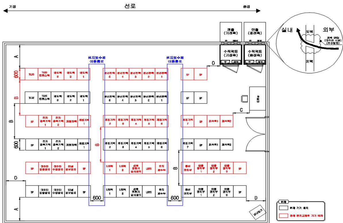
그림 1. 계전기실 기기 배치(예시)
