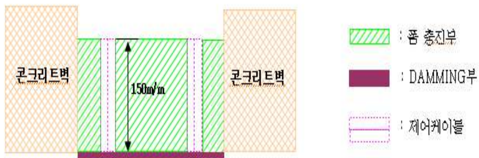
[그림 4-27] 시공방법2. 대형개구(수평) 충전부 측면도(X-X')
