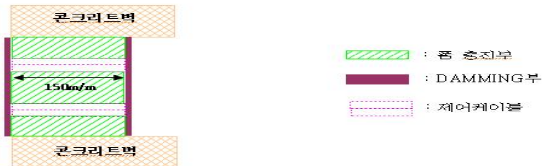
[그림 4-28] 시공방법3. 대형개구(수직) 충전부 측면도(X-X')
