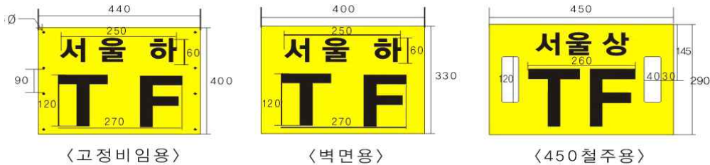
그림 7. 인출철구 급전선(AF), 전차선용급전선(TF) 표지 개념도
