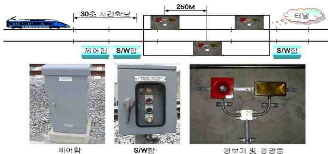
그림 11. 터널경보장치 시스템 계통도
