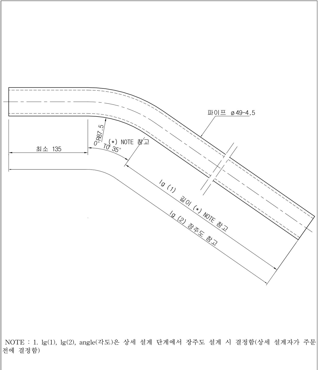
NOTE : 1. lg(1), lg(2), angle(각도)은 상세 설계 단계에서 장주도 설계 시 결정함(상세 설계자가 주문 전에 결정함)
