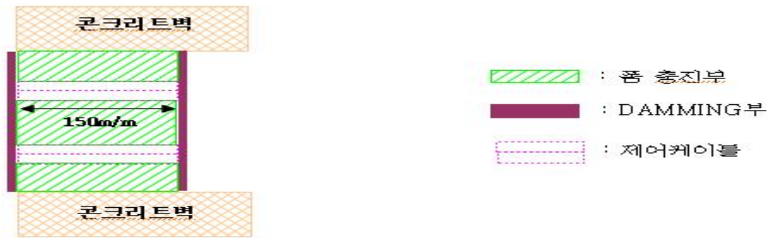
[그림 4-28] 시공방법3. 대형개구(수직) 충진부 측면도(X-X')
