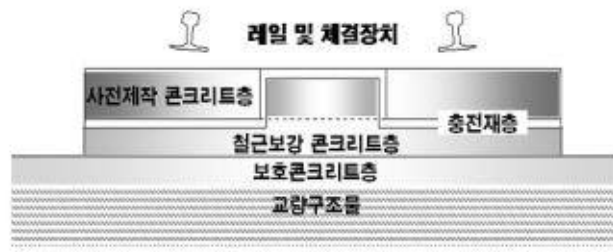
그림 18. 사전제작방식 콘크리트케도 교량부 구성요소
