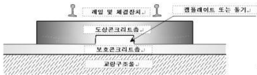
그림 17. 현장타설방식 콘크리트궤도 교량부 구성요소
