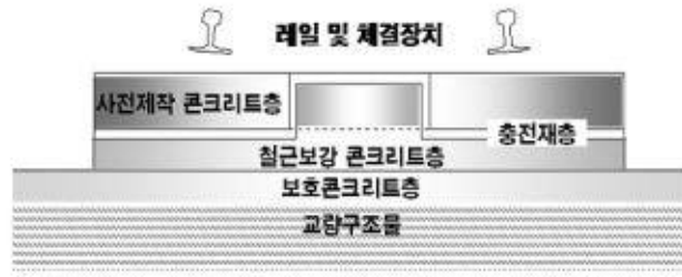
그림 18. 사전제작방식 콘크리트케도 교량부 구성요소
