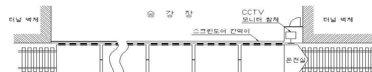
그림.1 광역철도 승강장 영상감시(CCTV) 설치 구성도
