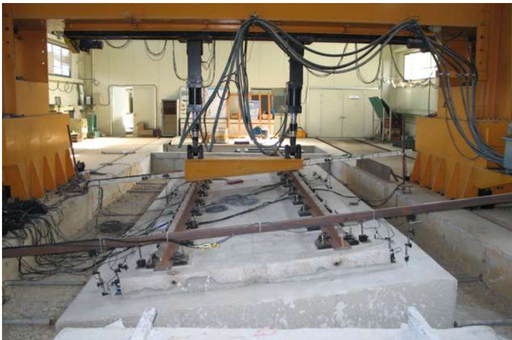
그림 4.1. 경사반복하중시험 개념도 및 시험 예시
