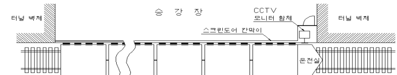
그림.1 광역철도 승강장 영상감시(CCTV) 설치 구성도
