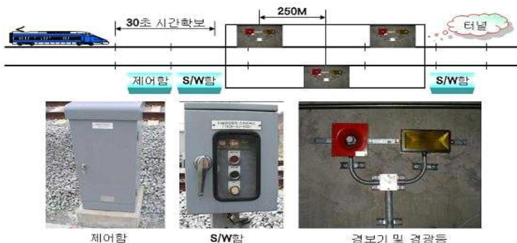
그림 11. 터널경보장치 시스템 계통도
