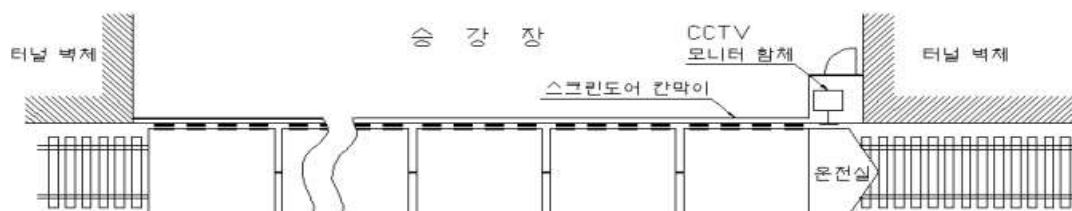
그림.1 광역철도 승강장 영상감시(CCTV) 설치 구성도
