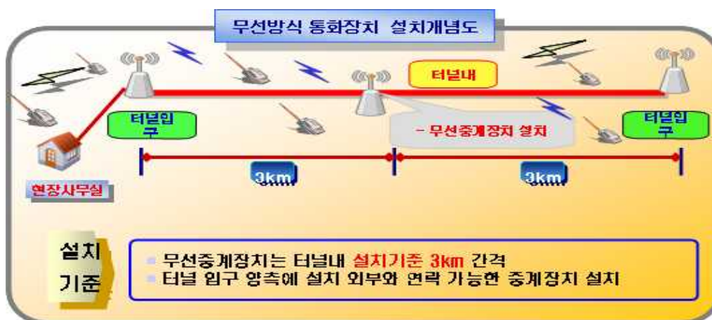
[그림3-2] 무선방식 통화장치 설치 개념도
