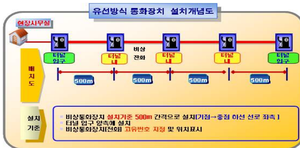
[그림3-1] 유선방식 통화장치 설치 개념도
