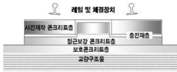
그림 18. 사전제작방식 콘크리트케도 교량부 구성요소
