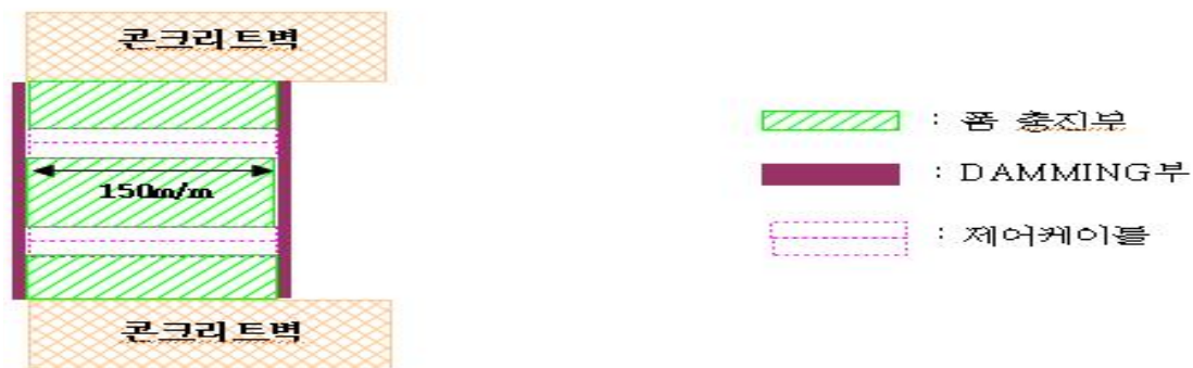
[그림 4-28] 시공방법3. 대형개구(수직) 충전부 측면도(X-X')
