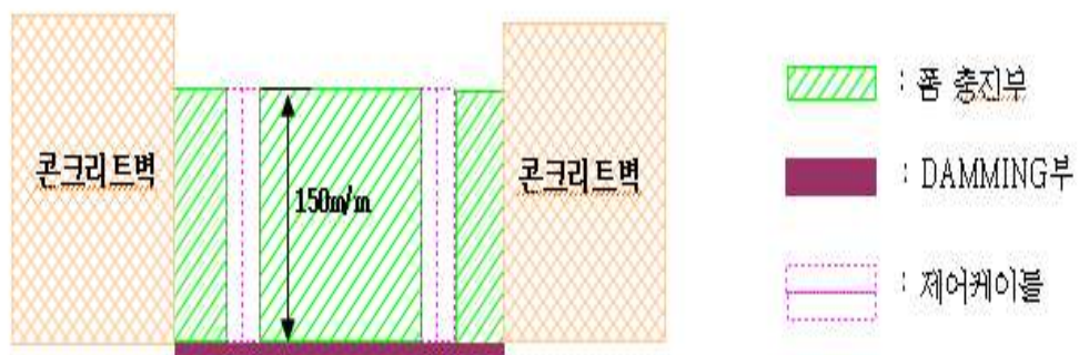
[그림 4-27] 시공방법2. 대형개구(수평) 충전부 측면도(X-X')
