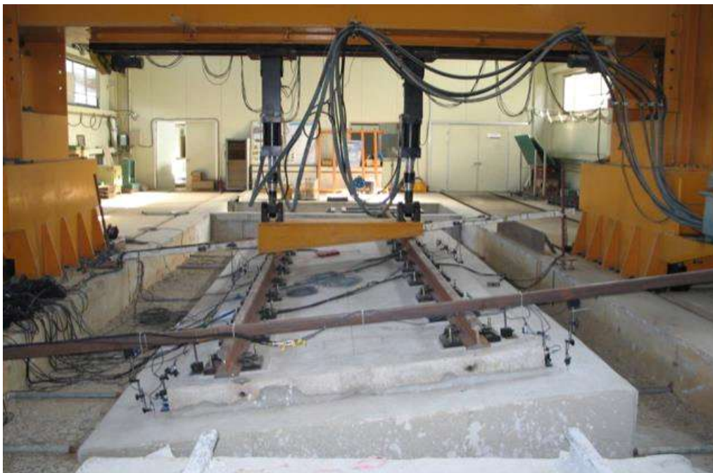
그림 4.1. 경사반복하중시험 개념도 및 시험 예시
