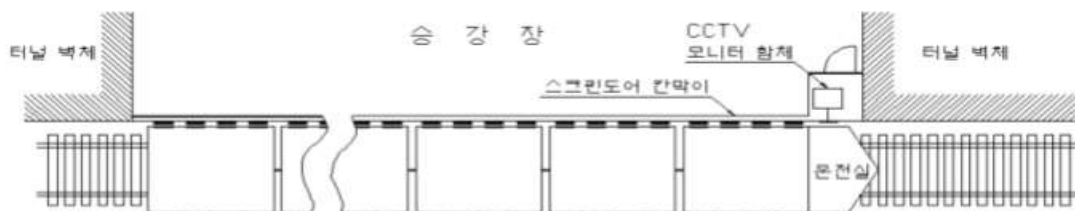
그림.1 광역철도 승강장 영상감시(CCTV) 설치 구성도
