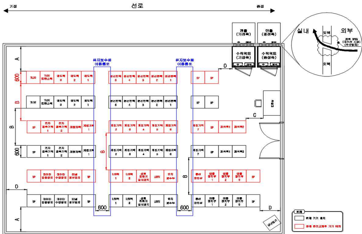
그림 1. 계전기실 기기 배치(예시)
