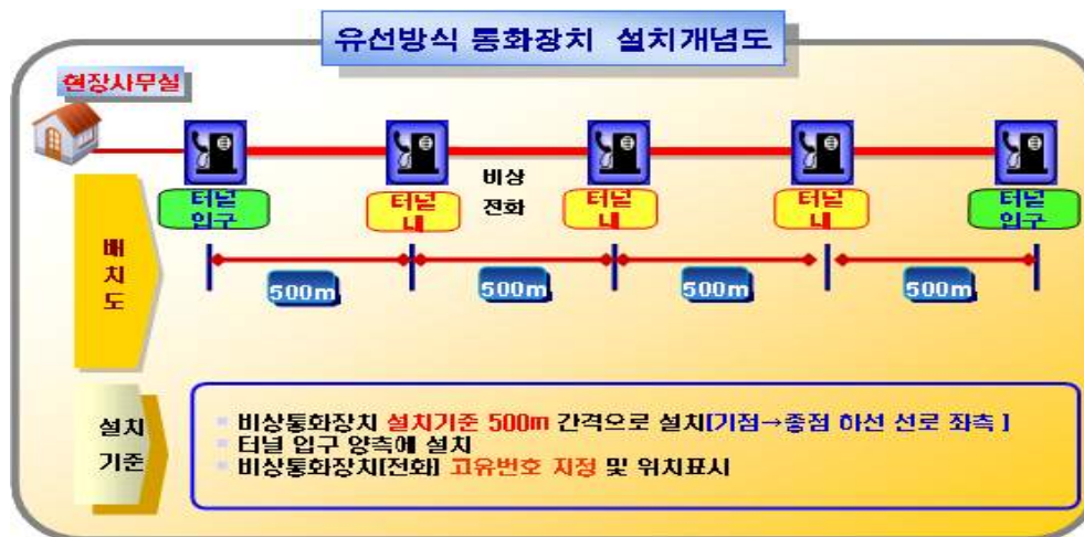
[그림3-1] 유선방식 통화장치 설치 개념도
